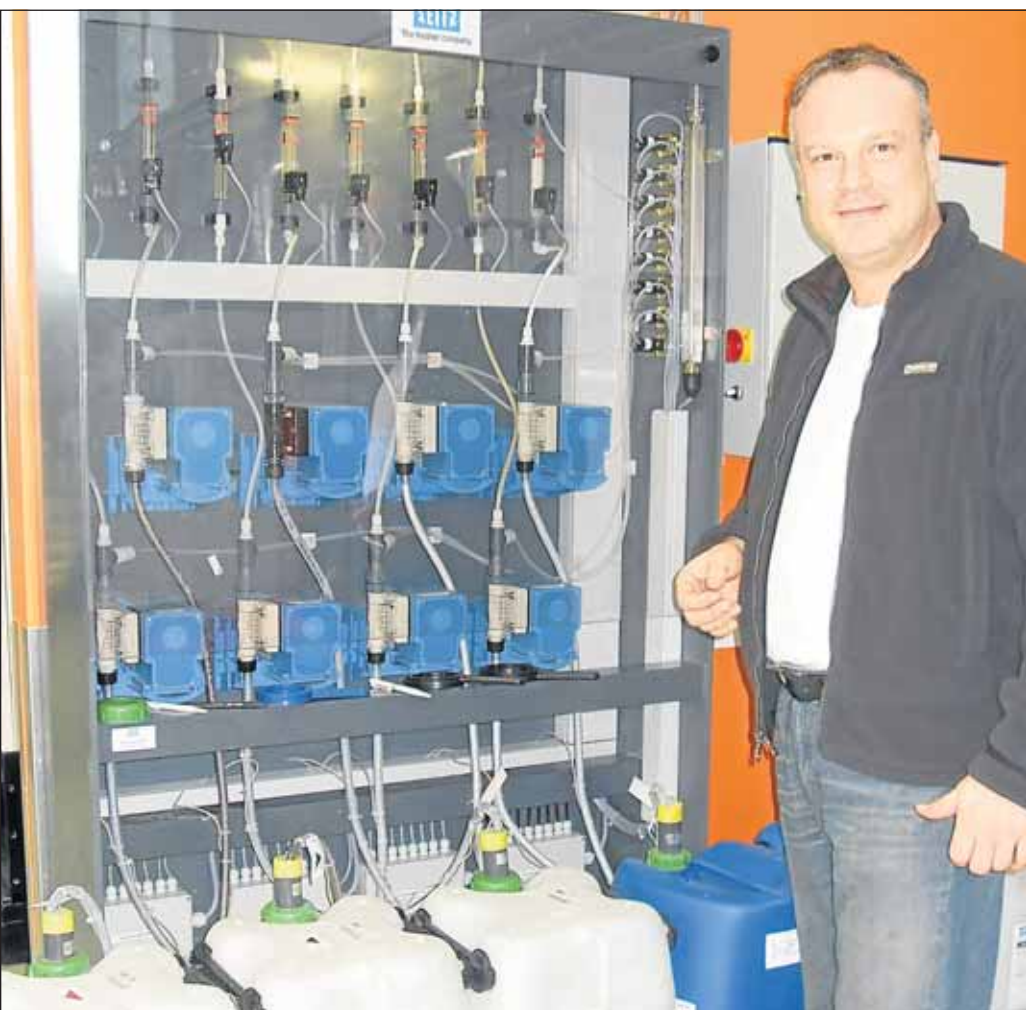
Robert Krainhöfner von KS Cleaning erklärt uns, wie seine Waschmitteldosieranlage das benötigte Produkt über eine SPS Steuerung auf den Tropfen genau dosiert. Die vorsortierten Wäscheteile werden somit nicht mit „unnötigen“ Produkten behandelt – Wäsche und Umwelt geschont. Das Kürzel „KS“ steht übrigens für „Konsequent Sauber“
